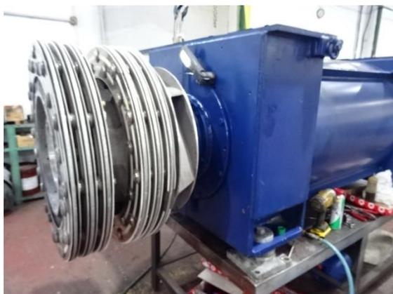
*Montaje de la resistencia del rotor*
