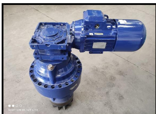
Fig. 17. Acabado Final Motor & Reductora.
